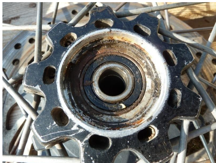
Le roulement droit est alors accessible.
