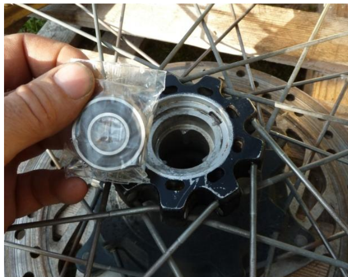
Il n'y a pas à se tromper, les roulements (droit et gauche) sont identiques.
