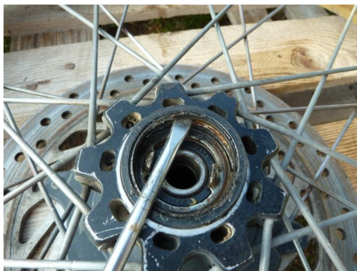
Décoller précautionneusement le cache-poussière.
