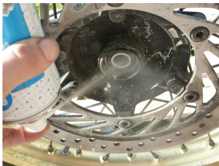
Bombe à l'envers, pulvériser suffisamment sur tout le roulement.
