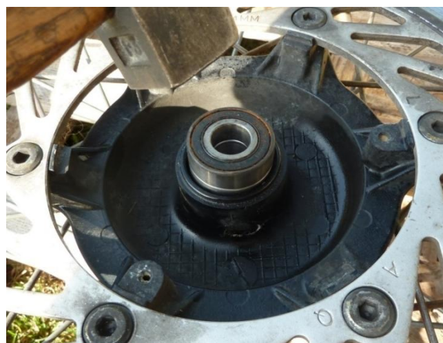
L'ancien roulement, posé sur le neuf, va nous aider à replacer celui-ci.
