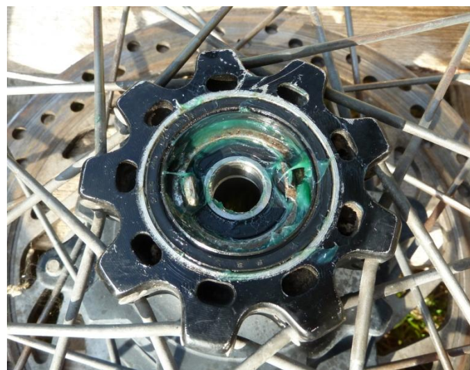
Bien positionné, le cache-poussière affleure le bord du moyeu.
