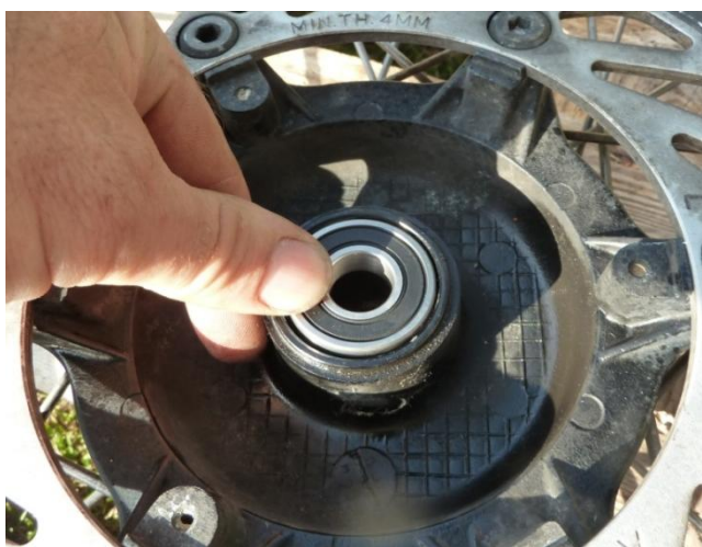
Le roulement neuf est juste posé sur sa cage mais pas enfoncé, malgré les apparences sur la photo
