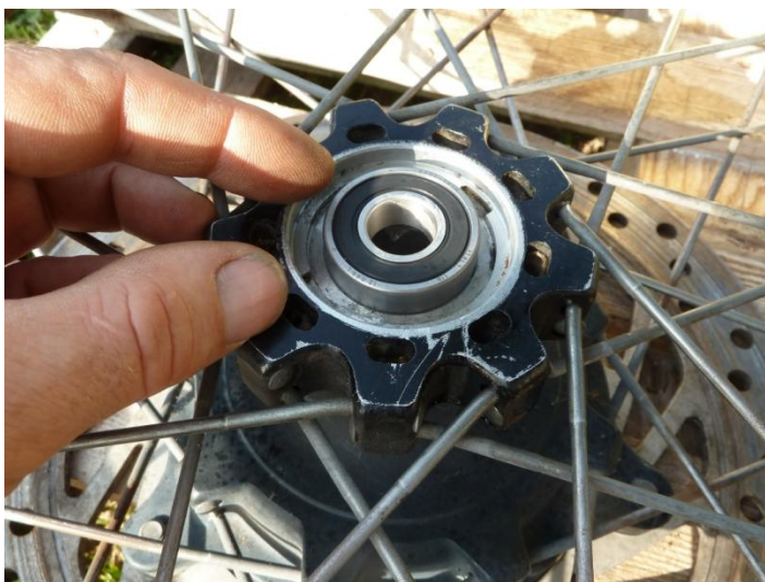
On place le roulement.
