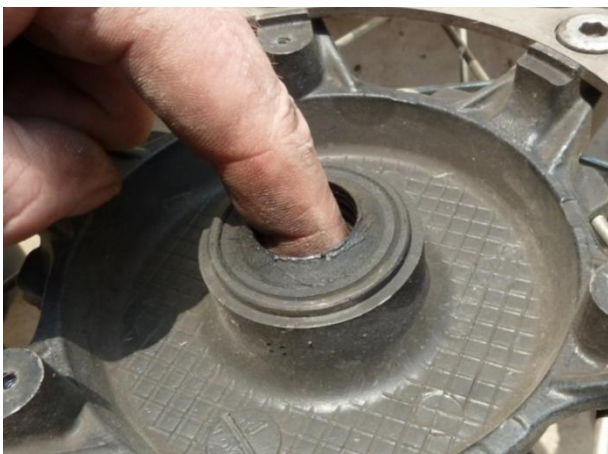
Penser à vérifier que les roulements tournent bien librement.
