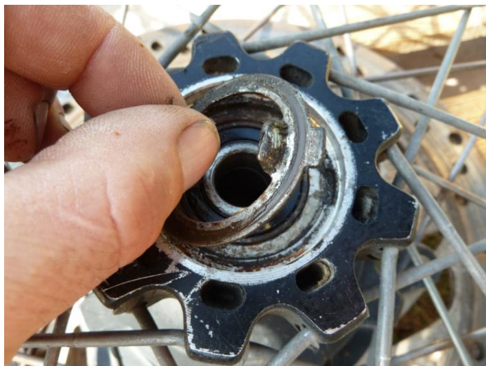
La rondelle (à ergots) de fixation de l'entraîneur s'enlève sans problème.
