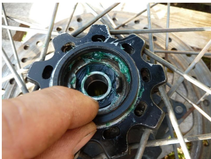
Mettre le cache-poussière dans le bon sens.
