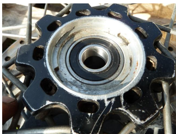
Le roulement est en place.
