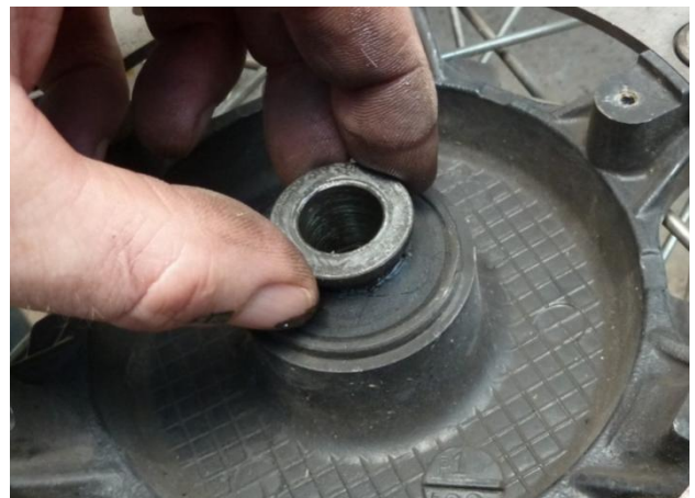
Remettre la bague pour le passage de l'axe de roue.
