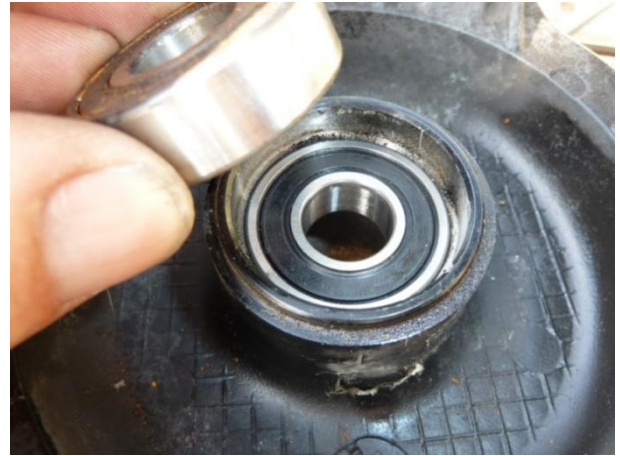
Et hop, on enlève l'ancien, le nouveau est en place.
