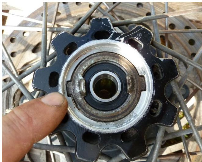
On voit bien les encoches du moyeu pour positionner la rondelle de fixation de l'entraîneur.
