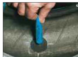
Etaler la dissolution sur la surface râpée. Laisser sécher 5 mn. Mettre une goutte de dissolution dans le canal de perforation.
