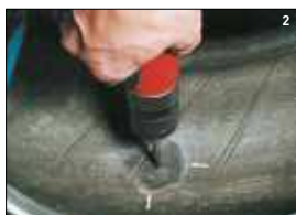
Mesurer la blessure pour le choix de la PRP. Aléser la perforation par l'intérieur en suivant sa trajectoire. (Outil tournant entre 1500 et 5000 t/mn maxi).
