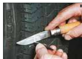
Après remontage et gonflage, couper (sans tirer). (Au flanc, couper à 1 ou 2 mm pour effet de rivet).
