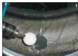
Râper sans appuyer, faire disparaître les stries éventuelles et dépoussiérer. (Outil tournant entre 1500 à 5000 t/mn maxi).
