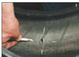
Démonter puis repérer la perforation à l'intérieur.
